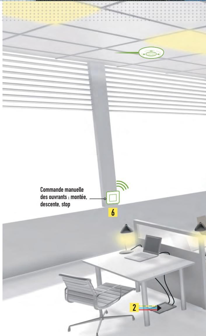
Commande manuelle des ouvrants : montée, descente, stop
