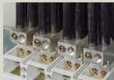
Raccordement de 4 conducteurs 240 mm 2 par pôle avec bornes grande capacité réf. 262 70 sur un DPX 1600
