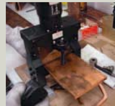
Pliage d'une barre cuivre épaisseur 10 mm sur outillage hydraulique portatif
