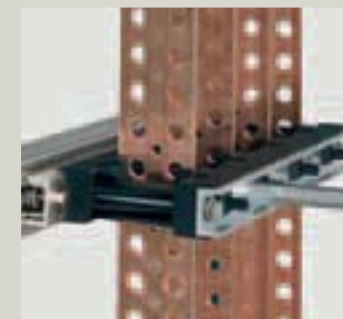
L'interposition de traverses en aluminium sur les supports de jeux de barres Legrand évite la création de cadres magnétiques
