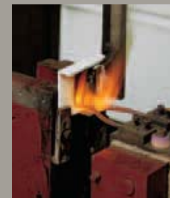
Les enveloppes XL 3 répondent aux règlements de sécurité des ERP : autoextinguibilité à 750 °C
