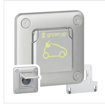
Prise de recharge pour VE Green'up Access avec volet - IP55 IK10 - Fixation saillie ou encastrée- Modes 1 ou 2 - 16A 230V
