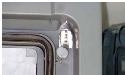
Plombage des vis de la face avant
