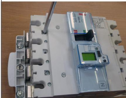
Solidariser l'appareil et la base à l'aide des vis de fixation fournies avec la base.
