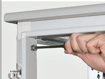
Fixer le toit à l'aide des vis M8 à tête fraisée puis bloquer définitivement toutes les vis de montage de la structure.
