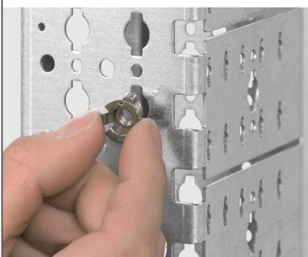
Montage des clips-écrous
