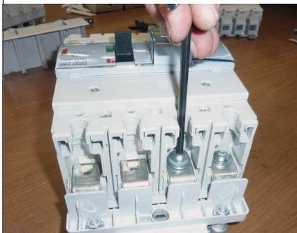
Réaliser les connexions électriques amont avec les vis fournies avec le disjoncteur (clé 6 pans de 4mm pour DPX<sup>3</sup>160 couple de serrage de 7 N.m, clé de 6 pans de 5mm pour DPX<sup>3</sup>250 couple de serrage de 10N.m).
