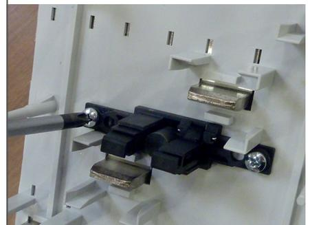
Fixer le kit à l'arrière de la partie mobile de la base support avec les deux vis fournies (couple de serrage 1 N.m).
