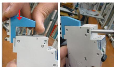
Installer le module de la même manière que sur les bornes automatiques de sorte que les dents du module de connexion s'insèrent dans les bornes du disjoncteur puis serrer au couple (1,6 à 2 N.m).
