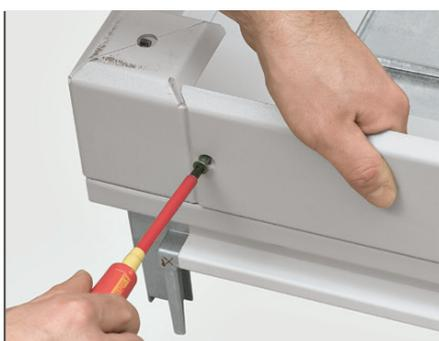
Monter les flancs latéraux suivant le besoin, puis retourner l'ensemble ainsi composé pour mettre en place les montants de structure.
