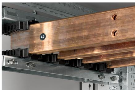
Ajuster la position du jeu de barres en profondeur pour raccordement avec les autres jeux de barres (serrage 20 Nm)
