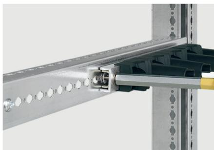
Fixer les supports sur les traverses à l'aide des vis M6 (serrage 10 Nm)
