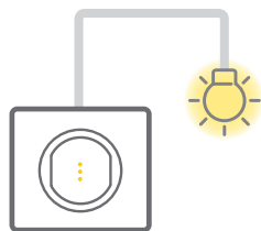
Interrupteur témoin : le voyant signale que l'éclairage est allumé.
