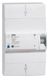
Disjoncteur de branchement Enedis tétrapolaire, pour tarif à puissance limitée (tarif bleu) permettant la coupure et le sectionnement de l'ensemble de l'installation ainsi que la protection contre les surcharges et les court-circuits
